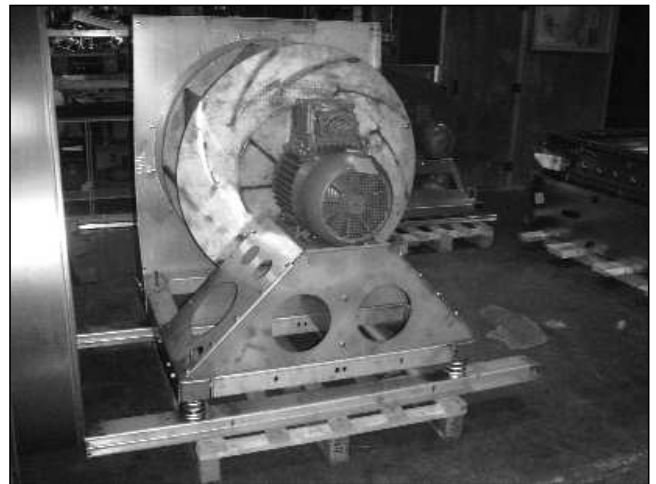
Вентилятор — свободное колесо (BCK6, BCK9) Dколеса=250..1250мм
